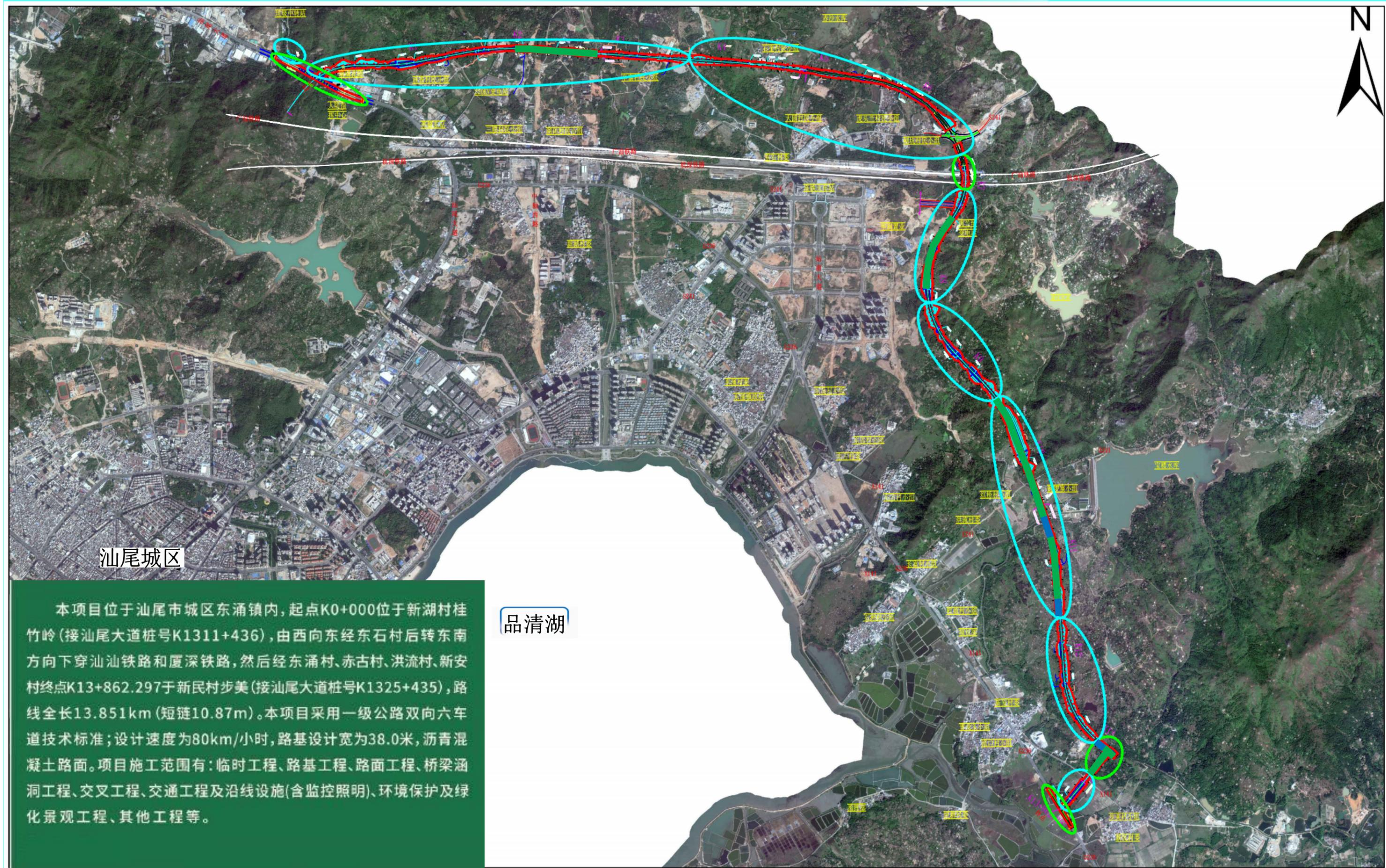
本项目位于汕尾市城区东涌镇内，起点K0+000位于新湖村桂竹岭（接汕尾大道桩号K1311+436），由西向东经东石村后转东南方向下穿汕汕铁路和厦深铁路，然后经东涌村、赤古村、洪流村、新安村终点K13+862.297于新民村步美（接汕尾大道桩号K1325+435），路线全长13.851km（短链10.87m）。本项目采用一级公路双向六车道技术标准；设计速度为80km/小时，路基设计宽为38.0米，沥青混凝土路面。项目施工范围有：临时工程、路基工程、路面工程、桥梁涵洞工程、交叉工程、交通工程及沿线设施(含监控照明)、环境保护及绿化景观工程、其他工程等。
