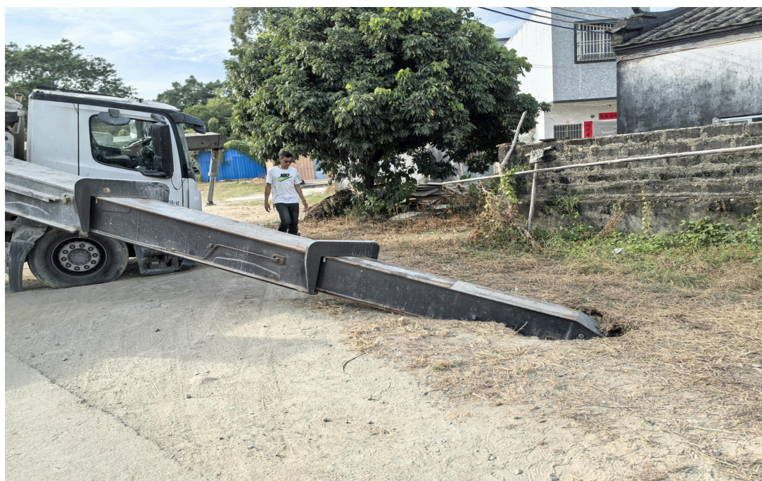
图 2：泵车右前支腿塌陷位置整体照片
