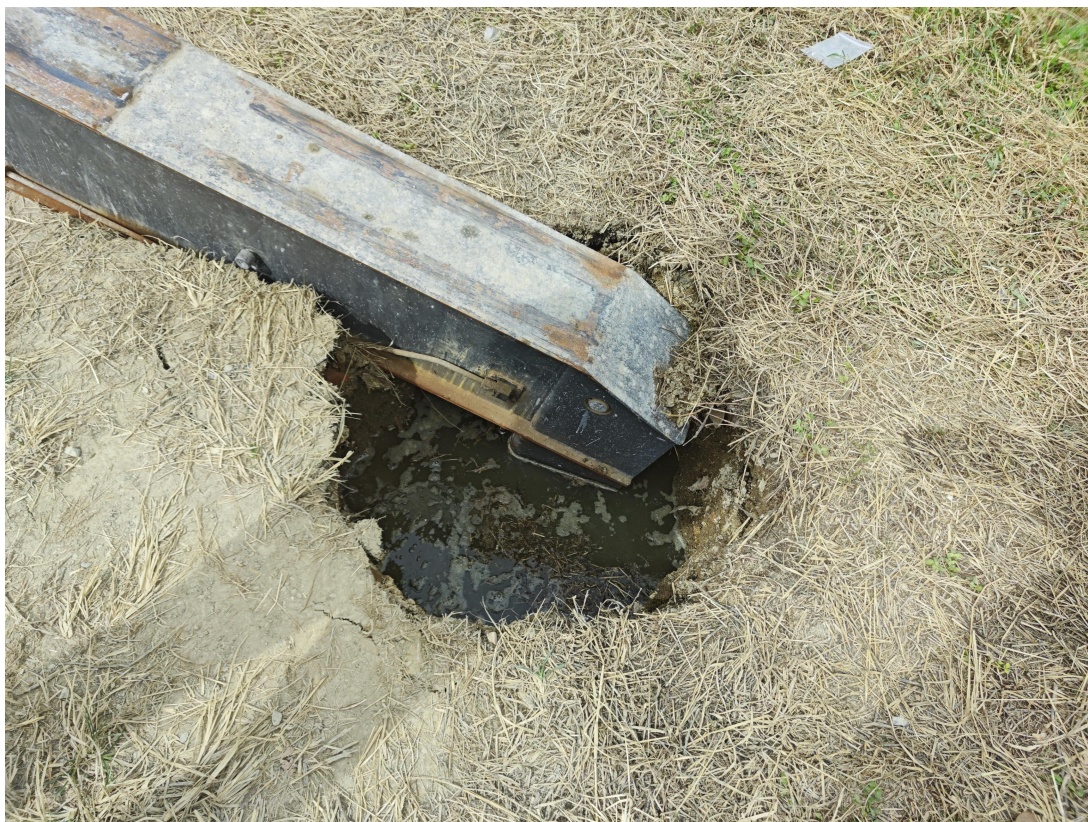
图 3：泵车右前支腿塌陷位置内部照片
