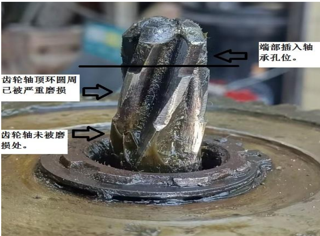
图 8 卷扬机高速齿轮磨损情况
